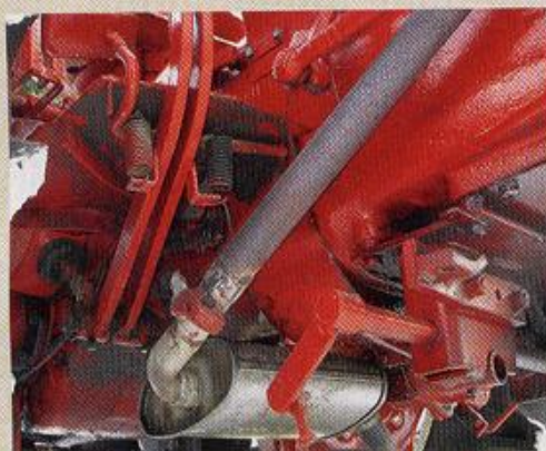
OBE Bremspedalverlängerungen, Rückholfedern. Im Hintergrund ist der Eingang der linken Bremspedalverlängerung in die Bremsglocke zu erahnen
