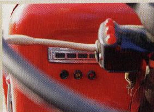
OBE Kontrollleuchten für Fernlicht, Kühlwassertemperatur, Öldruck und Ladekontrolle
