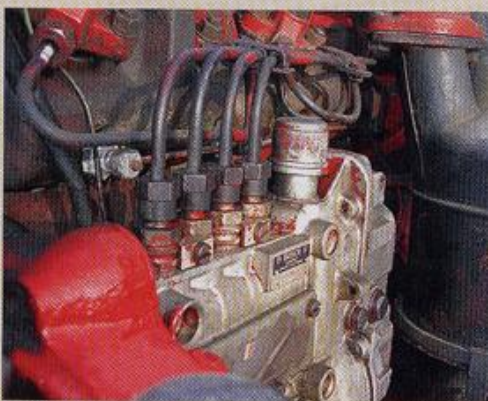
LINKS IHC 439: Einspritzpumpe von Bosch
