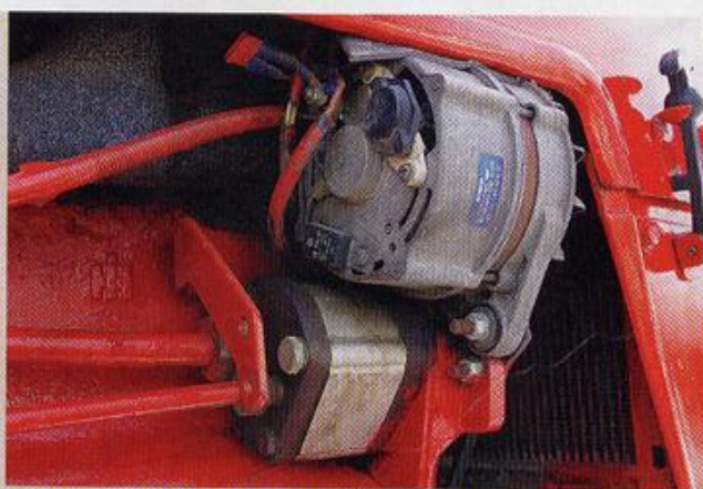
OBEN Lichtmaschine, darunter die Hydraulikpumpe
