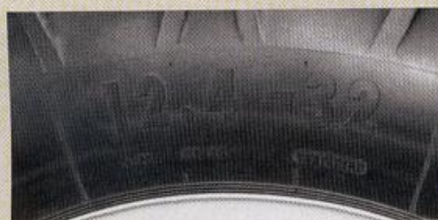
LINKS Hinterreifen der Größe 12.4 -32 (alte Bezeichnung: 11-32)
