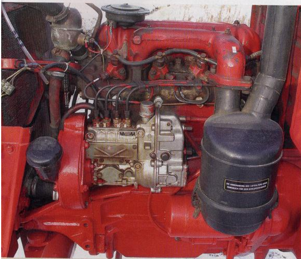
OBEN Motor, Einspritzpumpe und Luftfilter
