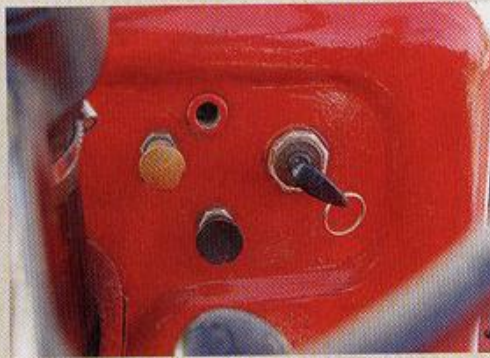
OBE Übersichtlich: links oben Warnblinkanlage, rechts Zündschloss, unten Anlasser
